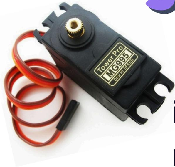
Motor eléctrico que lleva incorporado un sistema de regulación que puede ser controlado tanto en velocidad como en posición.
